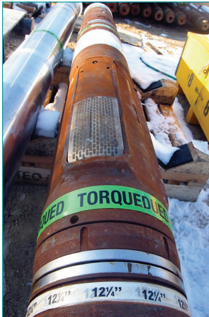
Abb. 3: RSS-Richtbohr-Tool vor dem Bohreinsatz in Pullach. Quelle: Erdwerk
